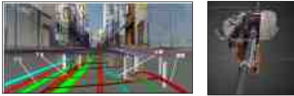
水道管路台帳の3次元化 ⇒埋設管の3次元点群データ取得 将来、電気、ガス等の占用事業者に展開
