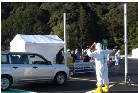
ゲートモニターによる車両検査
