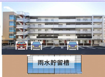
駐車場の地下に雨水貯留槽を設置
