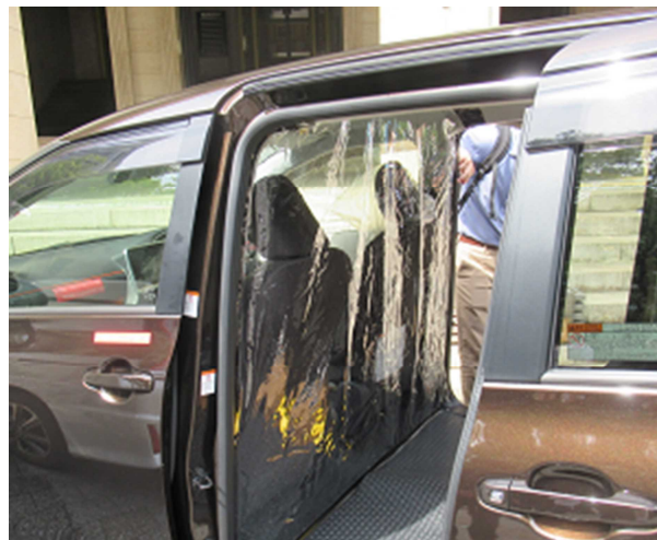
運転席と後部座席がセパレート型となっている搬送車両
