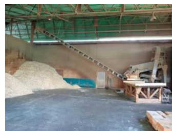
チップ加工機械と製造されたチップ
