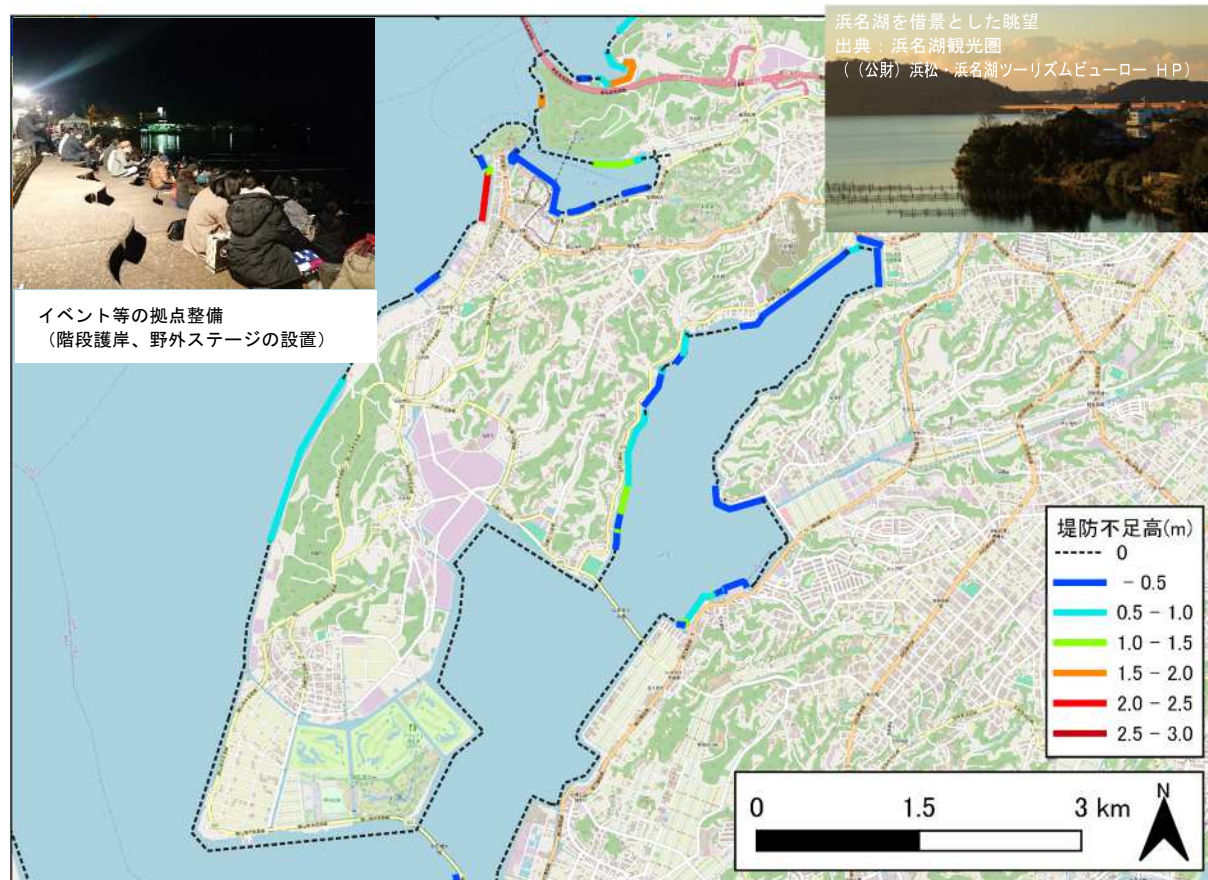
図 6.4 湖岸の防護目標に対する堤防の不足高（庄内・館山寺エリア）
