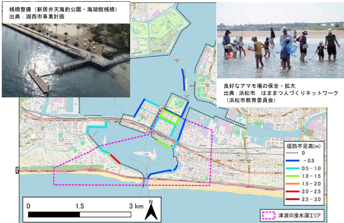
図 6.3 湖岸の防護目標に対する堤防の不足高（舞阪・弁天島・雄踏・新居エリア）
