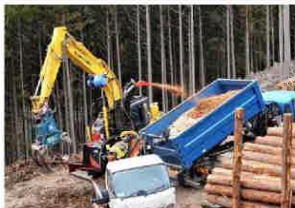
森林内での木材チップ生産の実証試験
