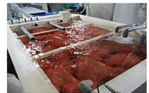
閉鎖循環システム(生物ろ過槽)
