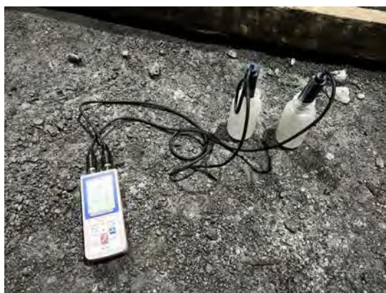
写真 6 ボーリング湧水の水質測定
