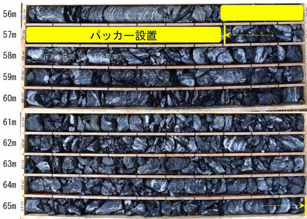
写真 4 孔内湧水圧測定 No. 2 (57.7m~66.0m) コア写真
