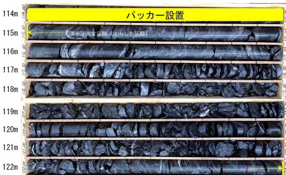
写真 5 孔内湧水圧測定 No. 3 (115.0m~123.0m) コア写真
