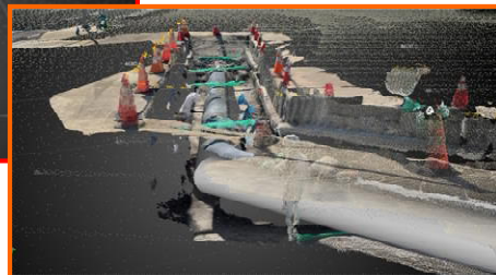
管路の3次元モデル化 (地下空間の可視化)
