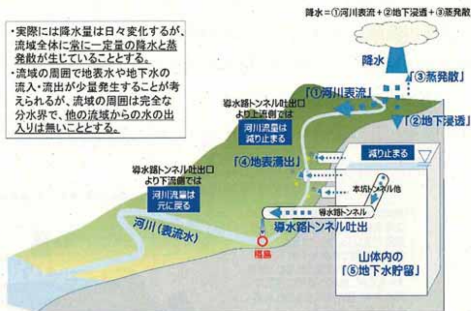
図 4 トンネル掘削完了後恒常時
