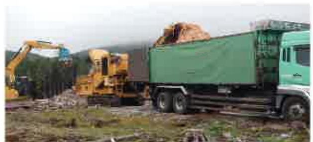
移動式チップパーによるチップ化
