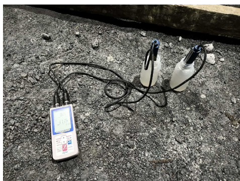
図 4 1 ボーリング湧水の水質測定
