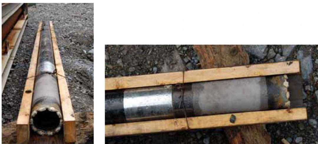
写真 1 コア採取ツール (コアチューブ：参考)
