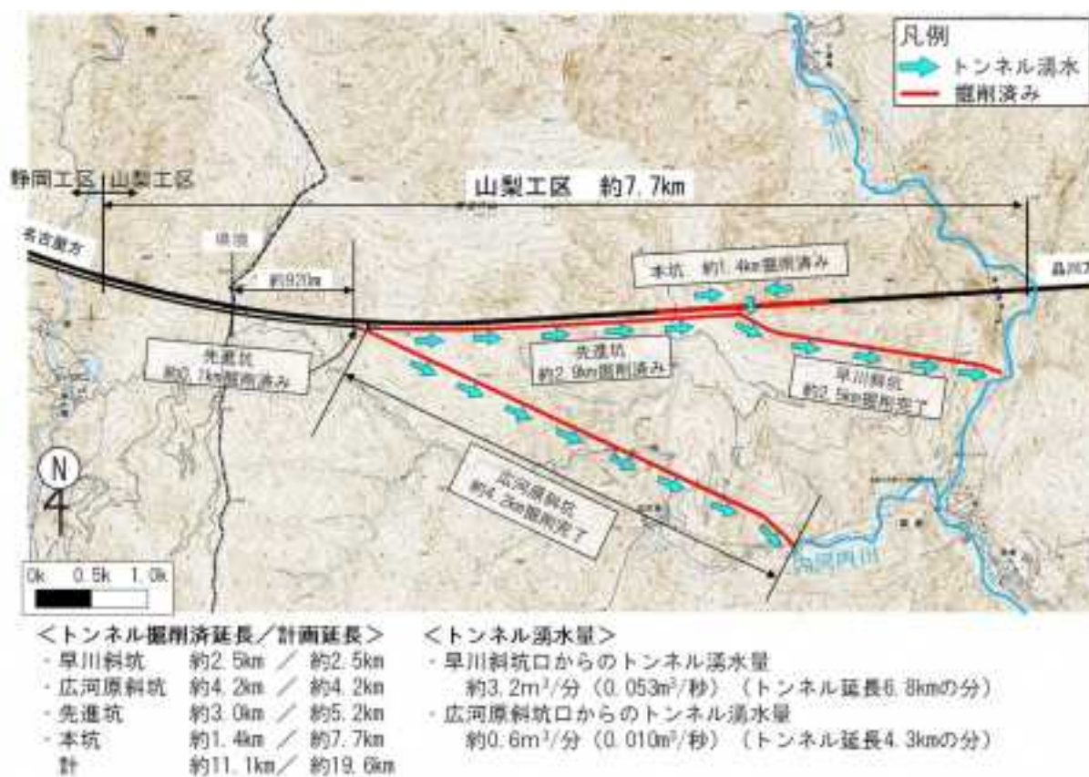
図8 山梨工区の進捗状況とトンネル湧水量(令和4年10月時点)
