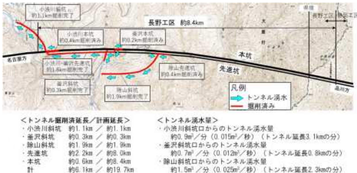
図13 長野工区の進捗状況とトンネル湧水量（令和4年10月時点）
