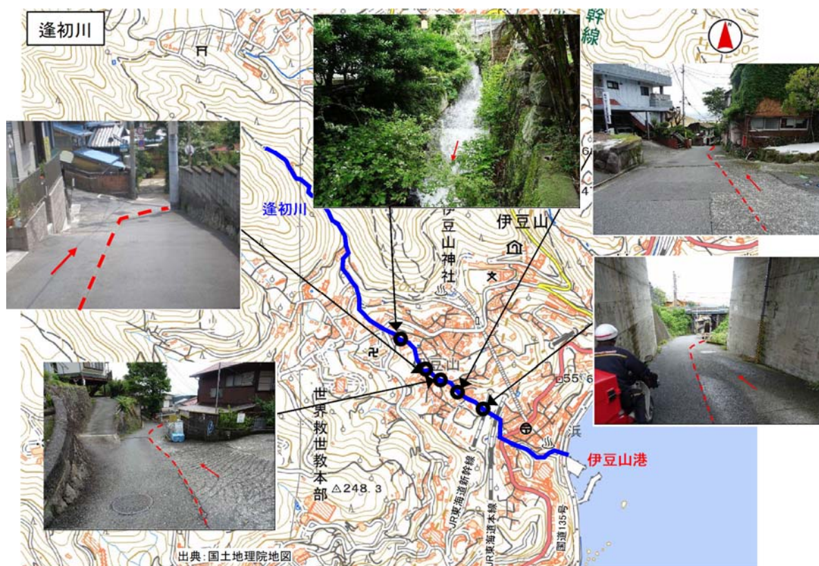
図 2-3 逢初川の暗渠区間
