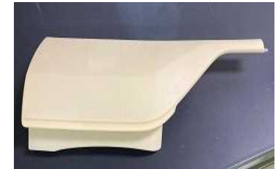
試作自動車部品 (連転云席前の収納ボックス部品)
