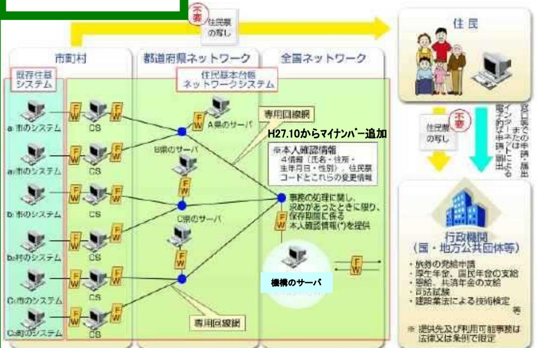
※CS(コミュニケーションサーバ)・・・各市町村に既に設置されている住民基本台帳事務のためのコンピュータと住民基本台帳ネットワークシステムとの橋渡しをするために新たに設置するコンピュータ
