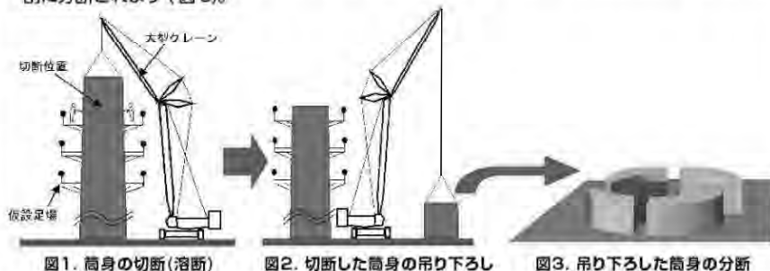
図1. 筒身の切断(溶断)
