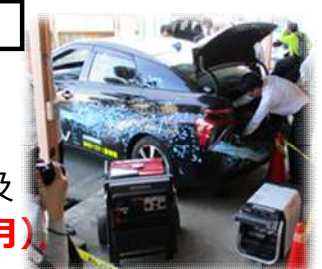
次世代自動車による外部給電デモ
