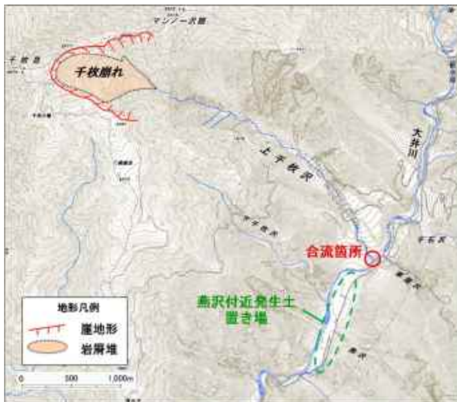
図 5 燕沢発生土置き場と崩壊地（千枚崩れ）との位置関係
