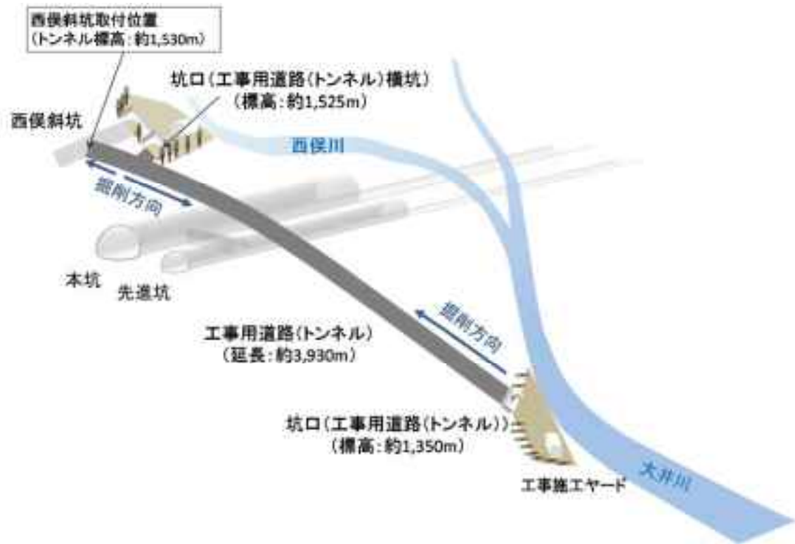
図 2.5 工事用道路 (トンネル) 概念図
