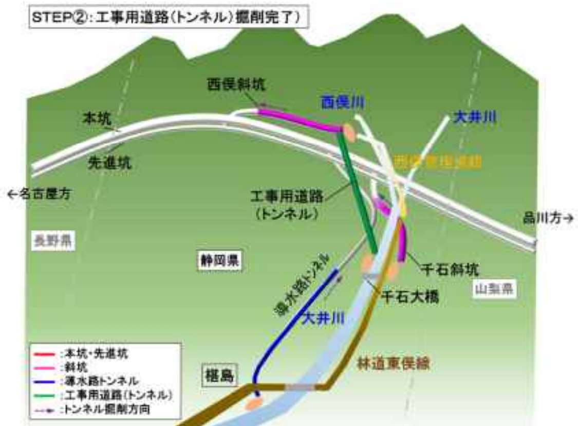
図 2.9 トンネル工事の進捗図 (STEP②)
