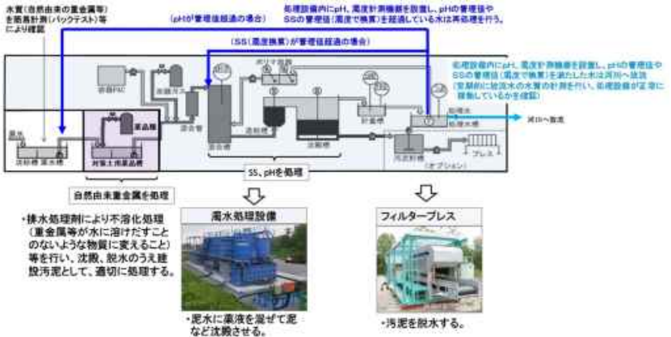
図 4.7 処理設備における処理のフロー (イメージ)
