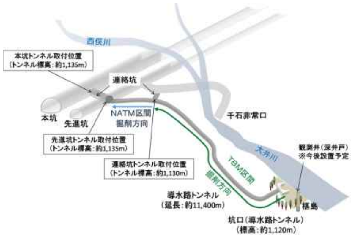
図 2.4 導水路トンネル 概念図
