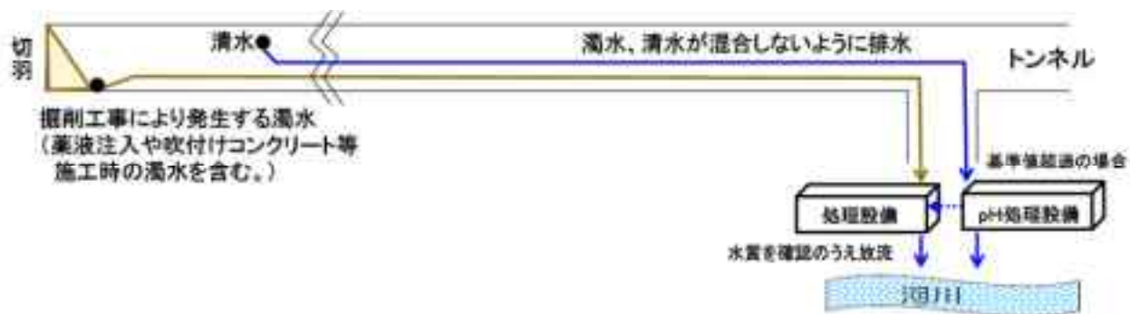
図 4.8 トンネル湧水の清濁分離（イメージ）
