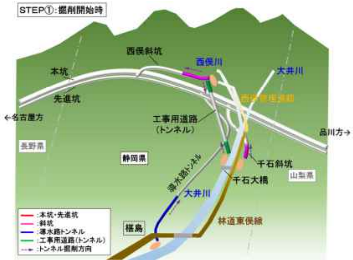
図 2.8 トンネル工事の進捗図 (STEP①)
