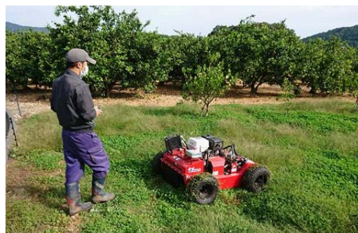
遠隔制御除草機での作業
