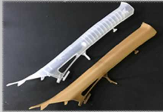
CNFを活用した自動車内装材 (フロントピラー、富士工業技術支援センター試作品)
