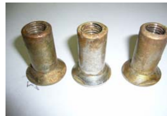
SUS304製 (錆び発生)
