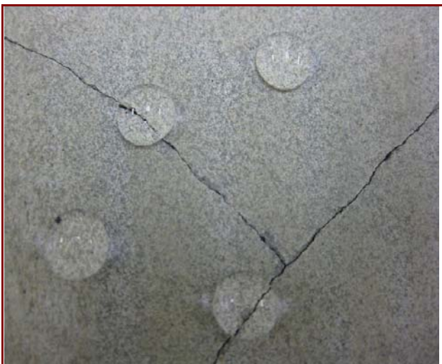
吸水防止効果 (クラック幅0.2mm)
