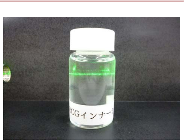
RCGインナーシール粒子コロイドの確認(チンダル現象)
