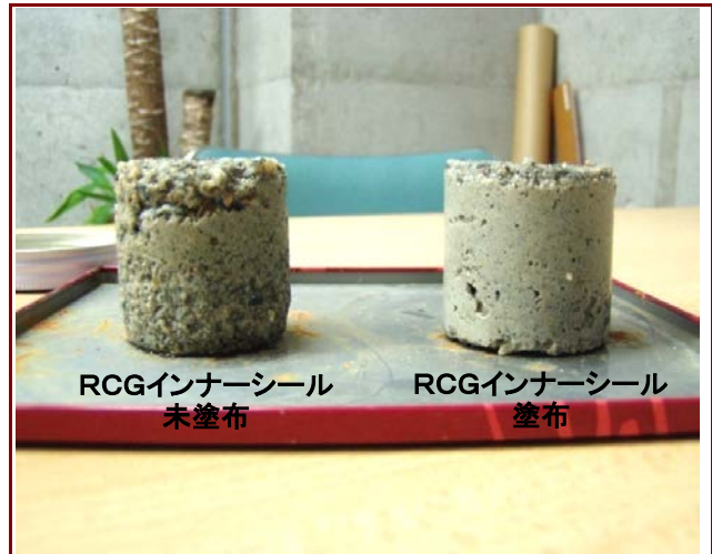
強酸(塩酸原液)による外観変化の検証
