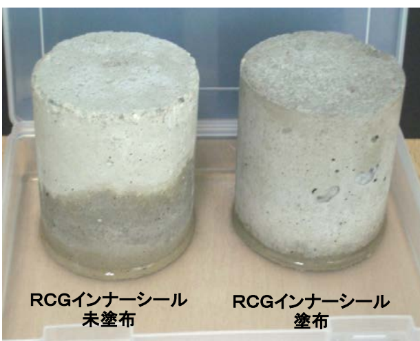
毛細管圧力作用の検証
