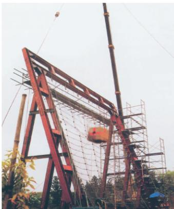
RCネットの性能を実証するため、数多くの実物実験が行われております。RCネットと落石の衝突する角度を想定し、落石のエネルギーとRCネットの挙動と耐力を検証しております。
