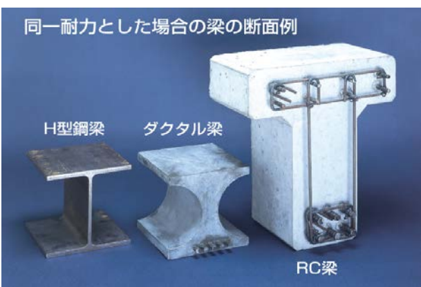
同一耐力とした場合の梁の断面例
