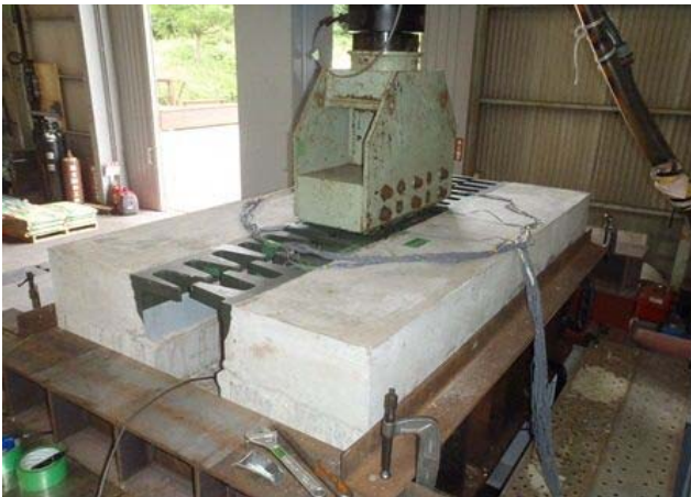
実物大試験体を用いた疲労試験の様子 (疑似床版上に伸縮装置を設置)
