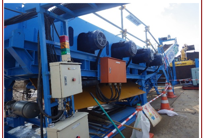
万能土質改良機(混合用土の攪拌・混合)
