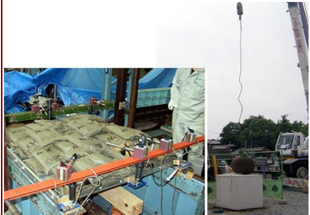
デコメッシュ強度試験・耐衝撃試験状況
