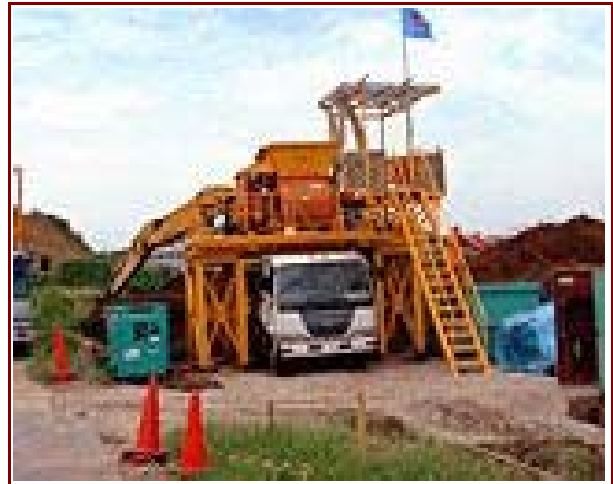
生育基盤製造装置 (定置式大型プラント)
