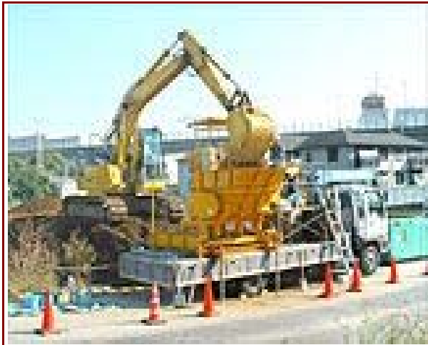
生育基盤製造装置 (移動式小型プラント)
