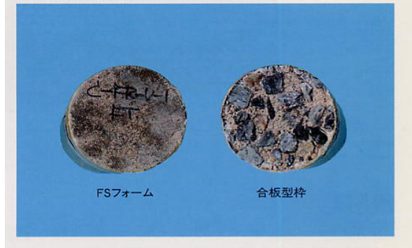
凍結融解による劣化状況比較
