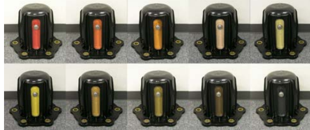
防錆油の色による内部判断
