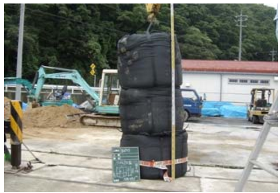
工場内:三段積み試験
