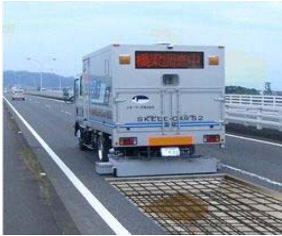
スケルカー(橋梁床版内部探査車)
