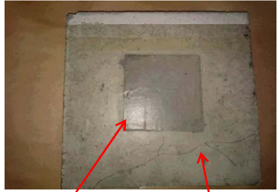
断面修復施工 仮想ひび割れ
