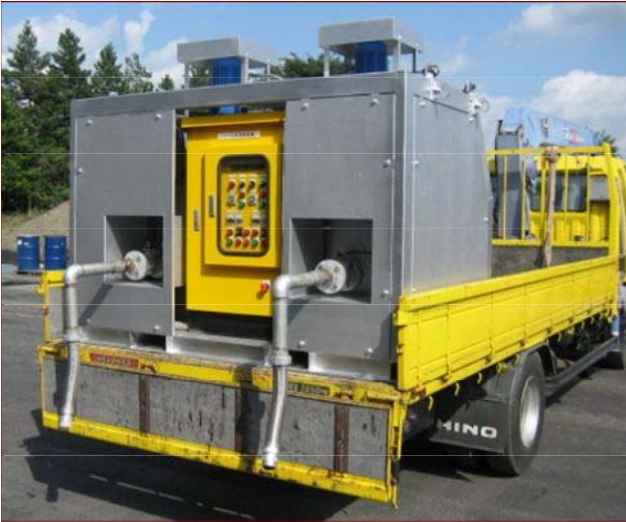
攪拌装置付き電気式溶解釜
