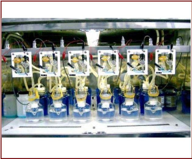
室内試験の例 (油脂類の生分解性試験)
