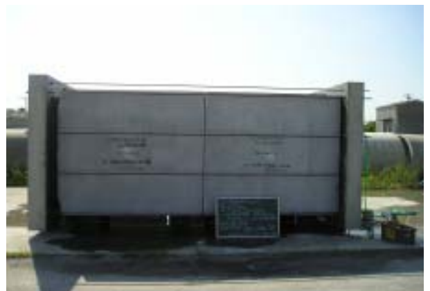
内水圧水密試験状況
