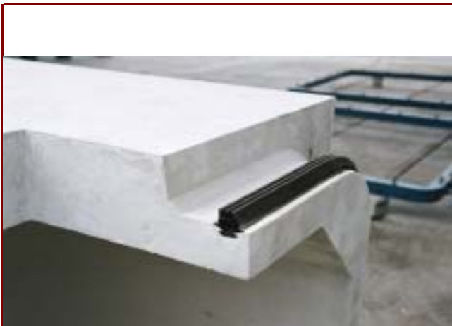
ゴムリング埋め込み状況
