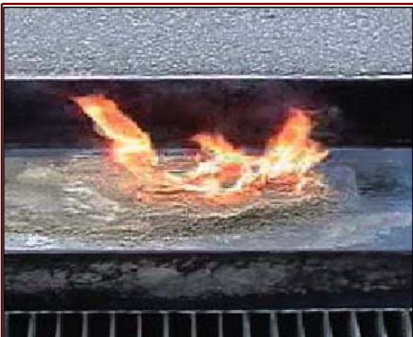
【引火性・着火性試験】砂・おが屑
