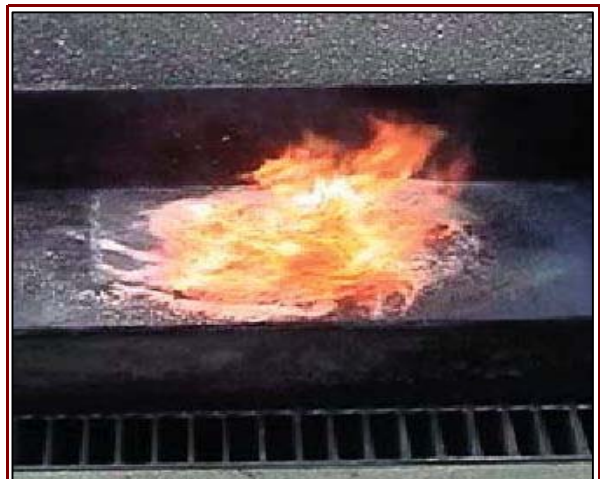
【引火性・着火性試験】油吸着剤
