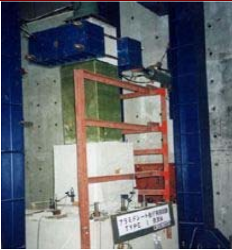
曲げ補強実験
