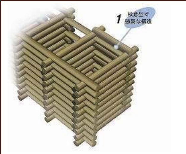
構造詳細 井桁形状
