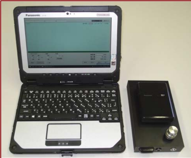
非破壊による鉄筋挿入工根入長さ測定装置
