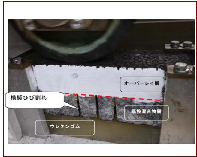
ひび割れ貫通試験状況
