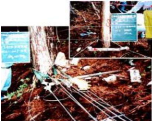
斜面上部の生立木の根株使用のアンカー (アンカー引張り試験)
