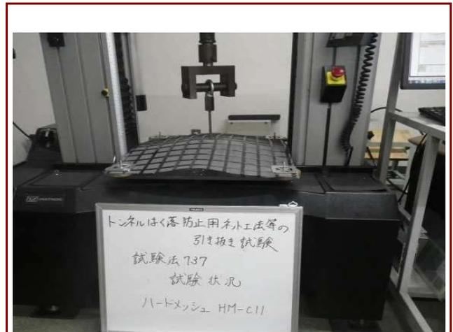
引き抜き試験状況
