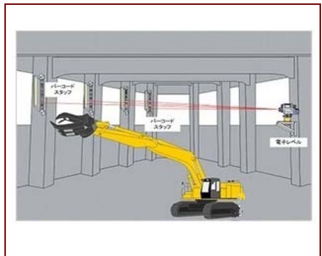
ビル解体時の柱の沈下を監視
