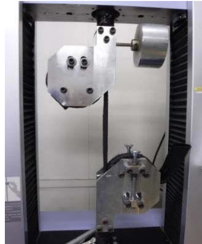
工場内 ベルト引張試験
