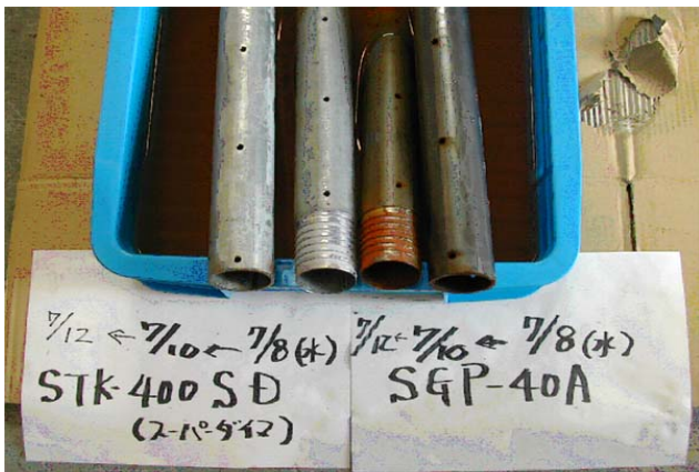
海水腐食比較
